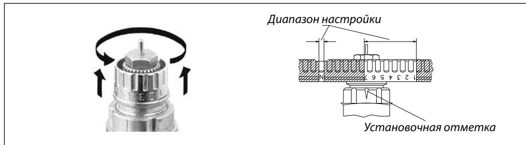
Клапан RA-N позволяет легко и просто выполнить предварительную настройку без использования специального инструмента. Для этого следует произвести следующие операции:
