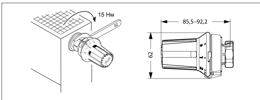
Монтаж терmostатического элемента серии RAW-K на клапан терморегулятора производится легко и быстро с помощью соединительной гайки M30 x 1,5. В процессе монтажа указатель температурной настройки должен находиться напротив цифры 5 на шкале термоэлемента. Термоэлемент
