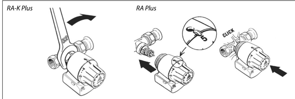
RA-K Plus закрепляется на клапане терморегулятора гайкой, которая закручивается ключом. RA Plus защелкивается на клапане без применения какого-либо инструмента легким
