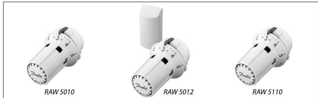
Термостатические элементы серии RAW — устройства автоматического регулирования температуры, предназначенные для комплектации радиаторных терморегуляторов типа RA. Радиаторный терморегулятор представляет собой пропорциональный регулятор температуры воздуха прямого действия с малой зоной пропорциональности, которыми в настоящее время оснащаются системы отопления зданий различного назначения.
