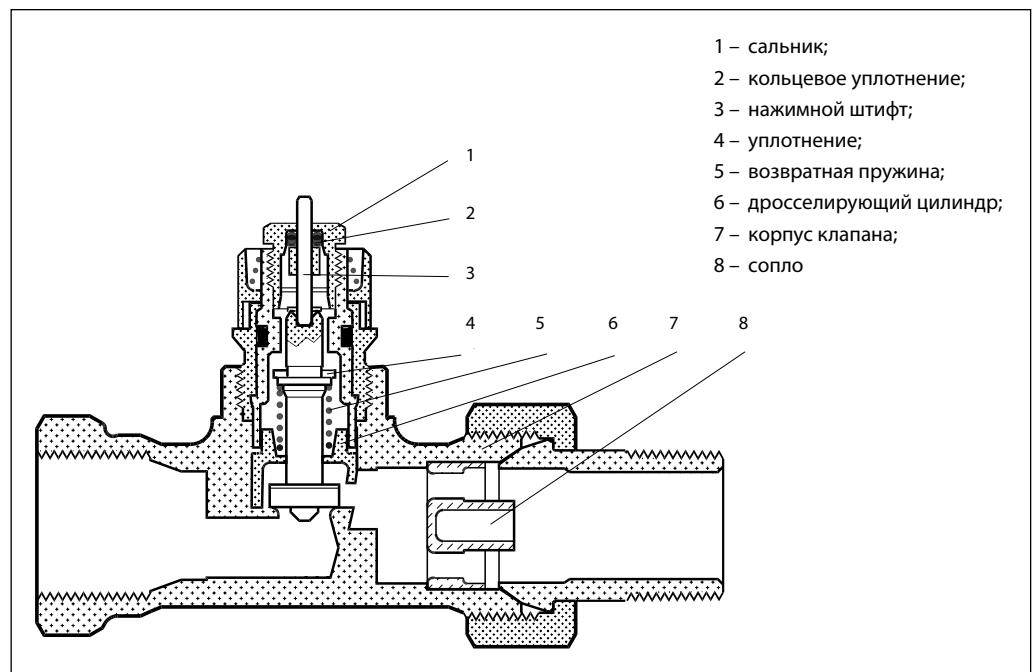
Радиаторный терморегулятор состоит из двух частей: универсального термостатического элемента серии RA и регулирующего клапана с предварительной настройкой RA-N. Термостатический элемент и регулирующий клапан заказываются отдельно.
