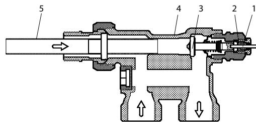
Клапан гарнитуры RA 15/6TB для двухтрубной системы отопления с патрубками для трубопроводов  $\frac{1}{2}''$
