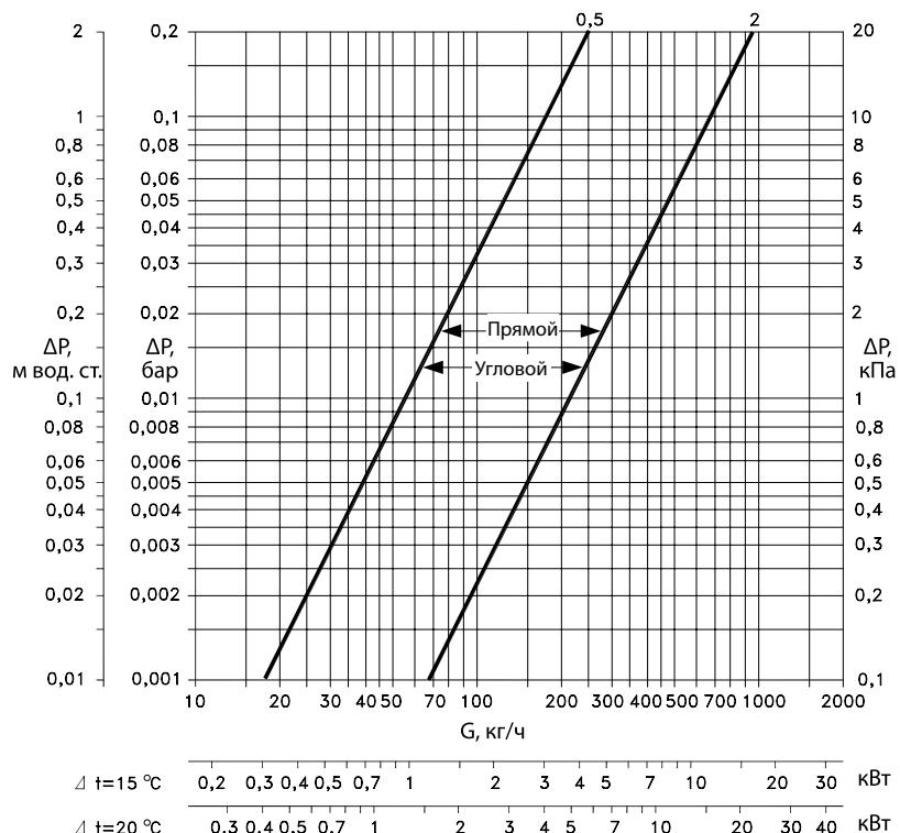
Характеристики приведены для клапанов в комбинации с терmostатическими элементами серии RA-2000
