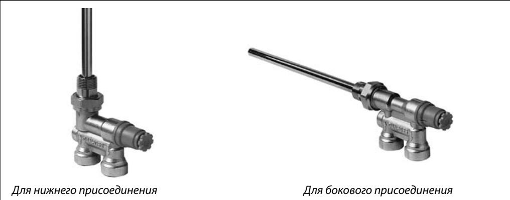
RA 15/6TB и RA 15/6T — гарнитуры со встроенным клапаном терморегулятора, предназначенные для «одноместного» присоединения радиатора (через одну пробку) к трубопроводам при их подпольной прокладке соответственно двухтрубной и однотрубной систем отопления.
