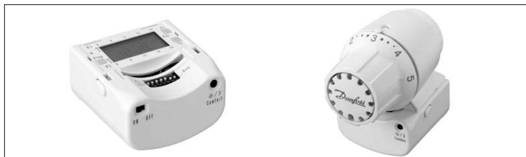
Программируемые терmostатические элементы RA Plus и RA-K Plus позволяют пользователю снизить температуру в отапливаемом помещении приблизительно на 3 °C в течение выбранных периодов суток и дней недели, уменьшая, таким образом, потребление тепловой энергии без отрицательного воздействия на комфорт.
