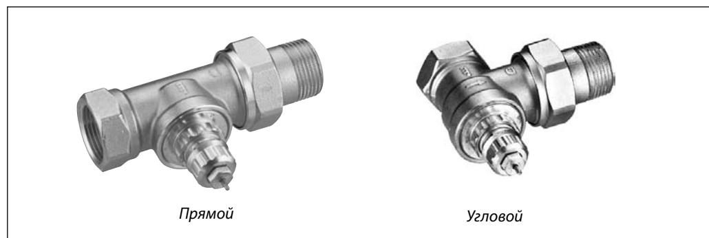
Клапан терморегулирующий с повышенной пропускной способностью RA-G предназначен для применения, как правило, в однотрубных системах водяного отопления с насосной циркуляцией теплоносителя, отвечающего требованиям Правил технической эксплуатации электрических станций и тепловых сетей Российской Федерации. Клапан не рекомендуется использовать, если в теплоносителе присутствуют примеси минерального масла.
