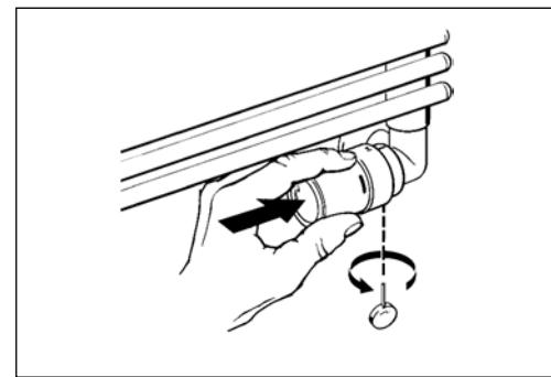
Самоуплотняющийся фитинг монтируется на полотенцесушитель с помощью 17-мм шестигранного ключа. У клапана терморегулятора и запорного клапана — согласующиеся конструкции. Желтый колпачок клапана может быть временно задействован для открытия и закрытия клапана. Запорный клапан представляет собой запорно-дренажное устройство. Все кольцевые уплотнения сделаны из тройного этиленпропиленового каучука. Это означает, что они не должны контактировать с нефтепродуктами.
